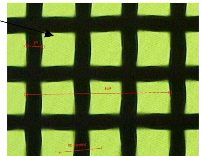
**HIGH FIELD RATIO REQUIRED FOR GOOD TRANSMISSION!**
