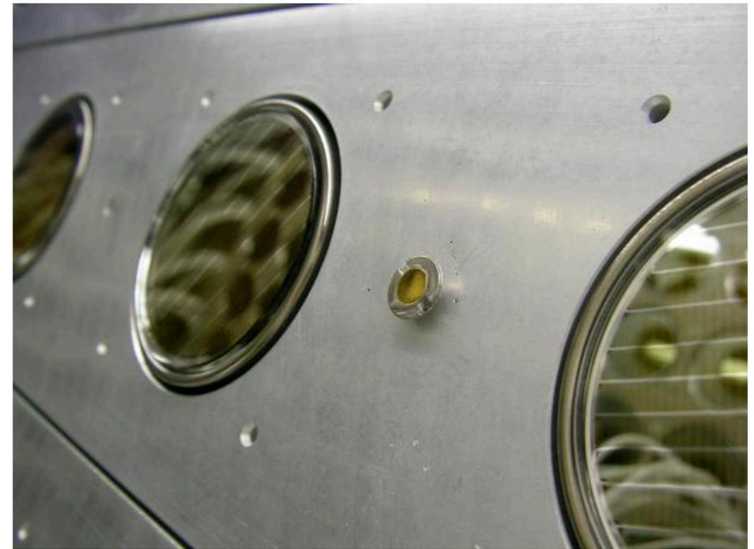
『MEGではこのプレートの裏側にネジをエポキシ接着剤(スタイキャスト)で接着して装置内に固定しています。
