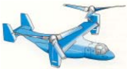
図 2.1 垂直離着陸機 (VTOL 機) の例
