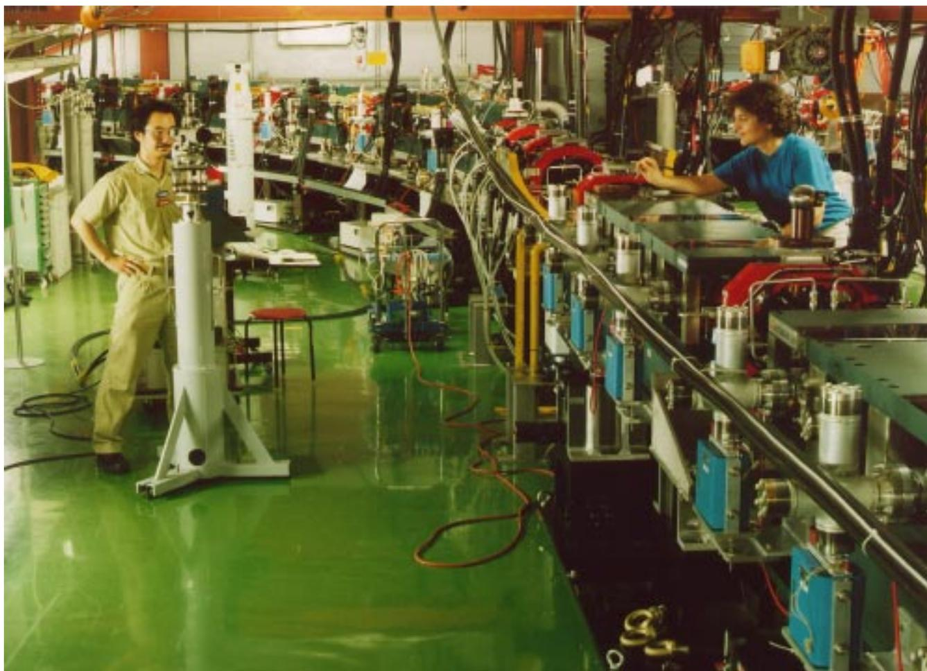
ATFのダンピングリング：周長約140mのレーストラック状の蓄積型リングで、直線部（写真右手前）に、放射減衰効果を高める多極ウィグラー電磁石が設置されています。また、全周にわたり合計96個のビーム位置測定モニターが備え付けられており、ビーム進行方向に対して水平、垂直位置を5～10μmの精度でビームの通過ごとに測定することができます。1997年1月より運転が開始され、水平方向のエミッタンスにおいては、すでに当初の目標が達成され世界最小の値が得られています。
