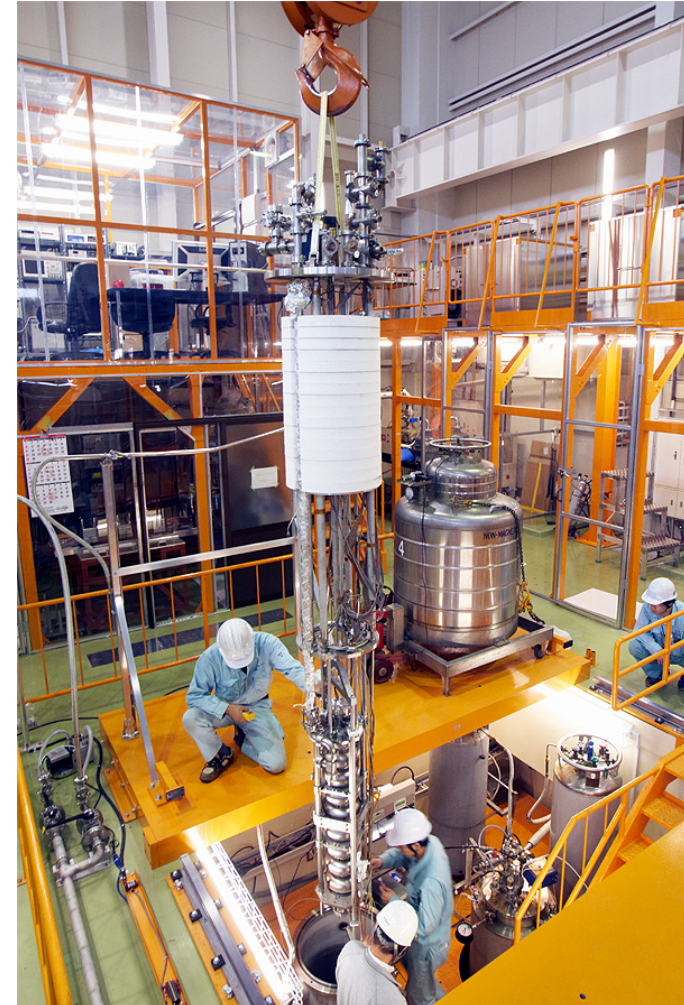
縦測定クライオスタットへの組込み試験
