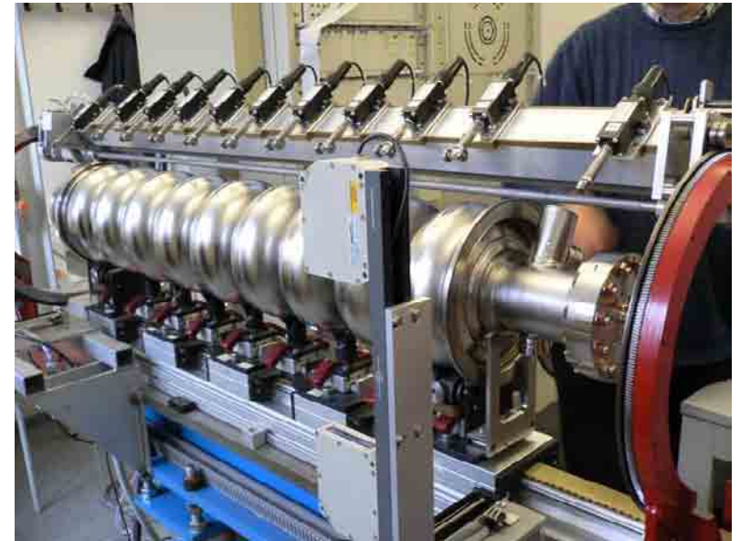
DESYの自動プリチューニング装置 これをXFEL用に発展的に改良するが、 DESY, FNAL, KEKとで共同で製作する。
