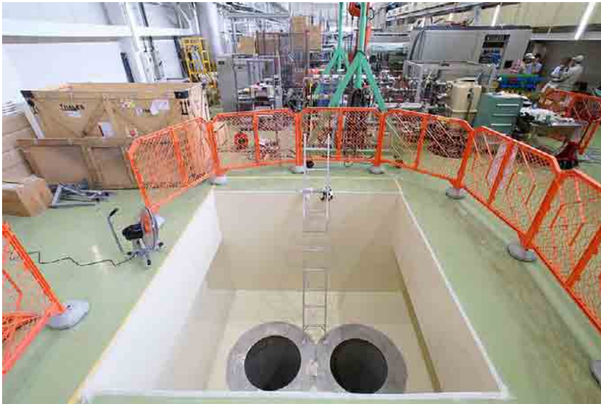
STF棟に建設中の縦測定設備 2台のクライオスタットを設置できる。
