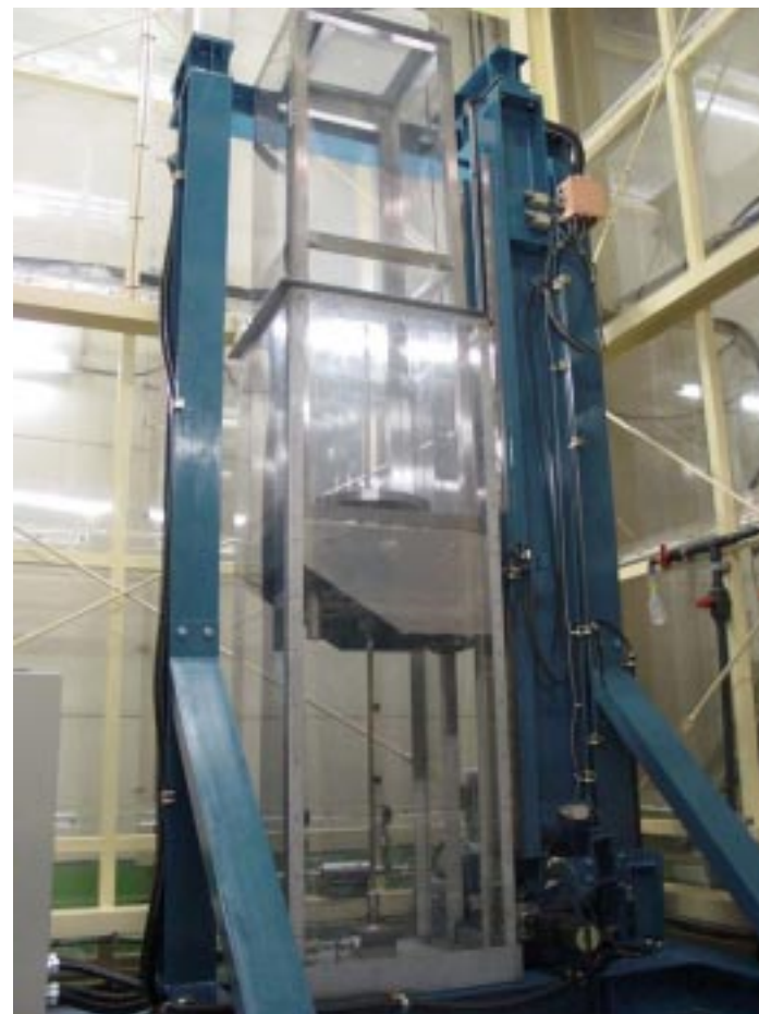
純水高圧洗浄装置 9-cell cavity用 AR 東第2実験棟
