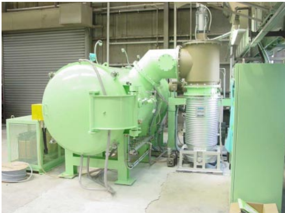
大型真空炉 (KEK機械工作センター) 仕様 : 800°C, ~E-6 Torr, Working zone 500 f x 3000L
