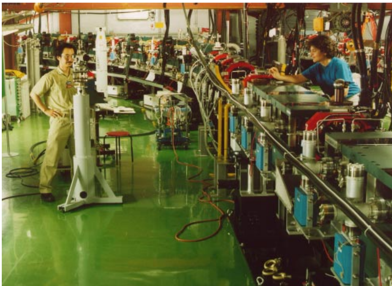
ATFのダンピングリング：周長約140mのレーストラック状の蓄積型リングで、直線部（写真右手前）に、放射減衰効果を高める多極ウィグラー電磁石が設置されています。また、全周にわたり合計96個のビーム位置測定モニターが備え付けられており、ビーム進行方向に対して水平、垂直位置を5～10 \mu mの精度でビームの通過ごとに測定することができます。1997年1月より運転が開始され、水平方向のエミッタンスにおいては、すでに当初の目標が達成され世界最小の値が得られています。
