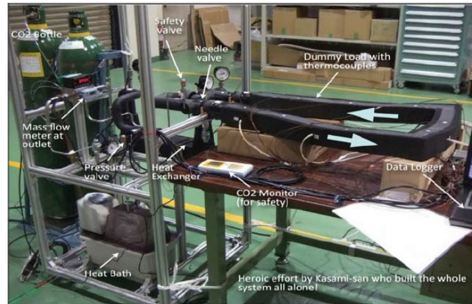
図 19 簡易 2 相 CO2 冷却システム
