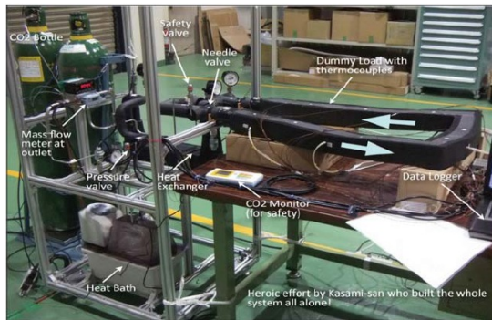
図 19 簡易 2 相 CO2 冷却システム
