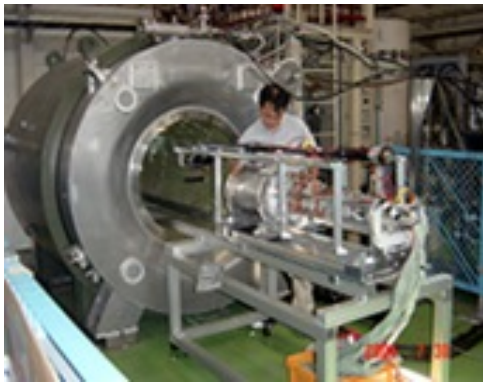
図 1 KEK 低温センターの 1T 電磁石中における MP-TPC (MWPC) と位置分解能
