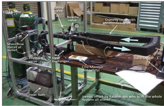
図 19 簡易 2 相 CO2 冷却システム
