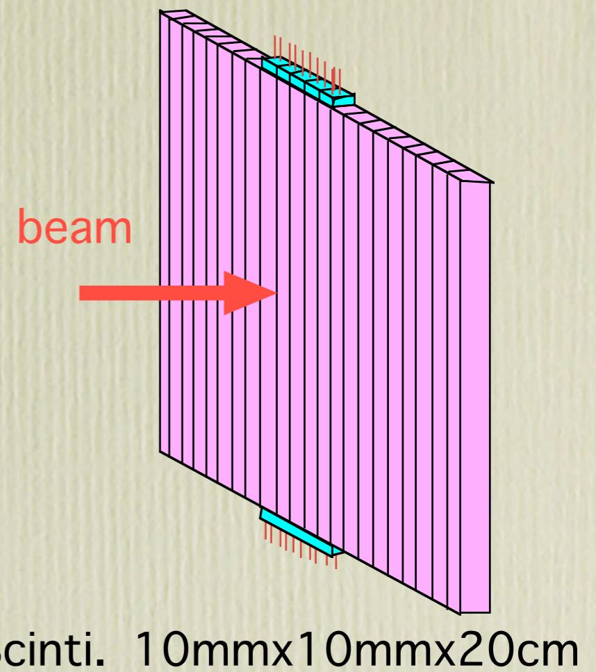
Scinti.  $10\text{mm} \times 10\text{mm} \times 20\text{cm}$
