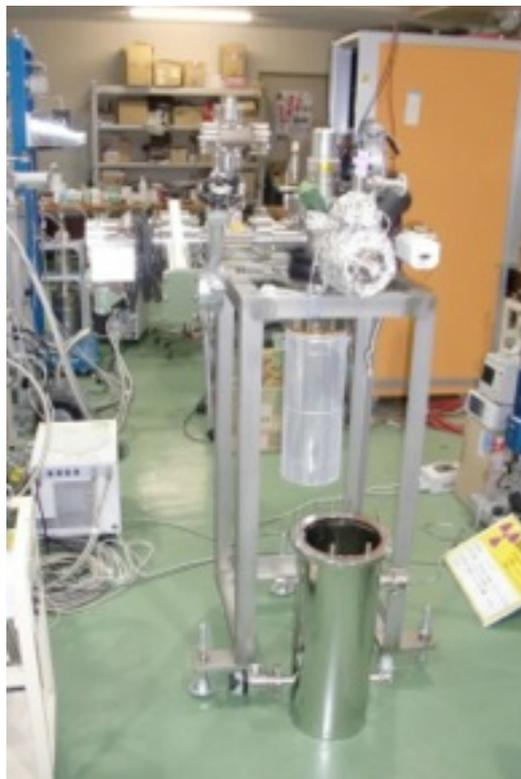
真空断熱・熱交換器
