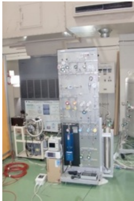
ガスハンドリングパネル
